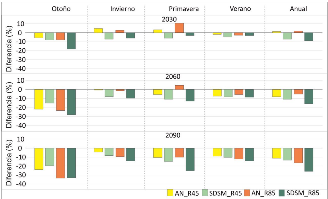
Figura 4.11: Diferencia (%) entre las proyecciones hidrológicas futuras y su baseline para Audikana. Para agrupar la diferencia en función del RCP (4.5 y 8.5) y el método de downscaling (SDSM o AN) se ha calculado el valor medio de la diferencia. Los datos aparecen separados en función de los horizontes 2030, 2060 y 2090 y en valores estacionales y anuales.
