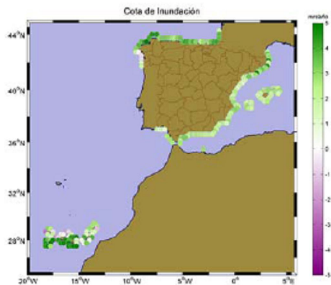
Nota: Variación anual en mm y probabilidad asociada de la cota de inundación en el litoral español hasta el año horizonte 2050.
