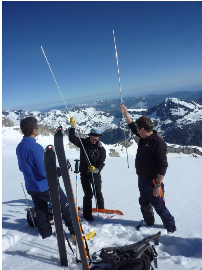
Parte superior del glaciar. Medida del espesor de nieve sobre la Baliza 20, cota 3.135 m, 610 cm de nieve
