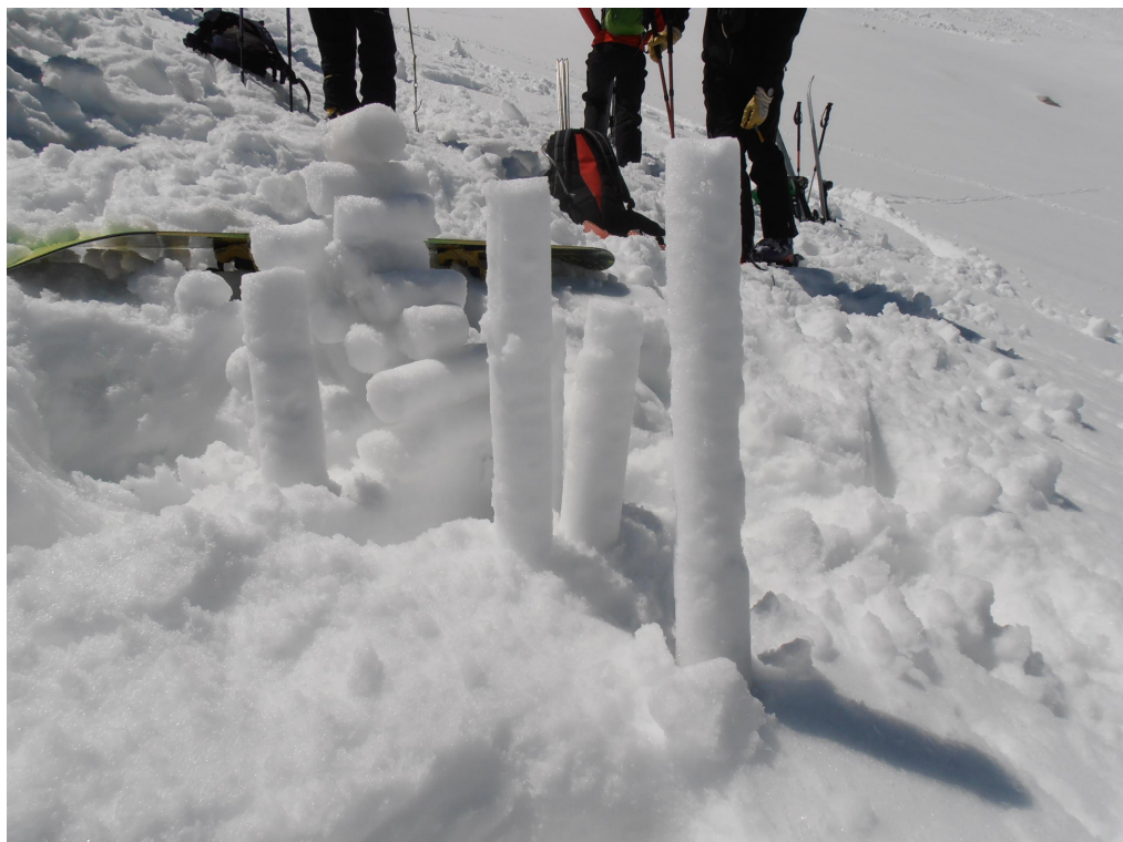
Parte intermedia del glaciar. Sondeo nº 3 cota 3.015 m. Testigos extraídos. Espesor total de 430cm
