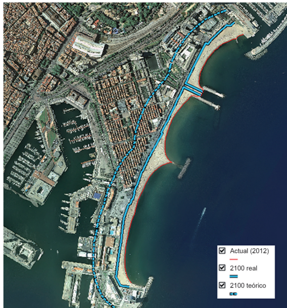
Figura 13. Evolución de la línea de borde de playa de la Barceloneta, causada por la subida del nivel del mar, considerando una playa de arena (caso teórico) y la existencia de infraestructuras rígidas (caso real).
