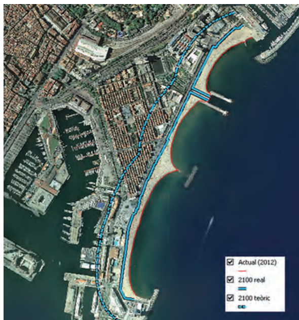
FIGURA 13 . Evolució de la línia de vora de platja de la Barceloneta, causada per la pujada del nivell del mar, considerant una platja de sorra (cas teòric) i l'existència d'infraestructures rígides (cas real).
