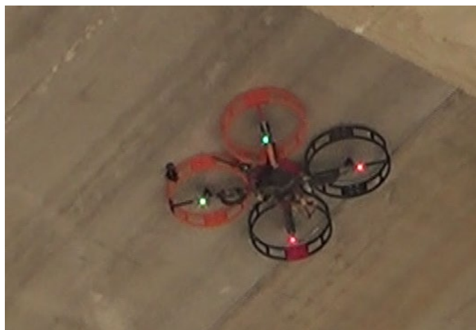
Figura 58. Prototipo de un vehículo aéreo no tripulado para la medición por contacto. El robot de inspección visual tiene por objetivo tomar fotografías de manera autónoma de puentes y túneles con los sensores desarrollados para encontrar y clasificar defectos visuales. Fuente: Jimenez-Cano et al, 2019 227 .
