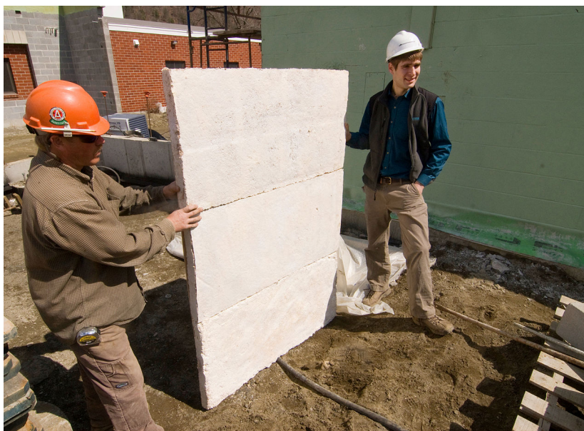
Figura 38. Panel de micelio y fibras vegetales. Fuente: Ecovative .
