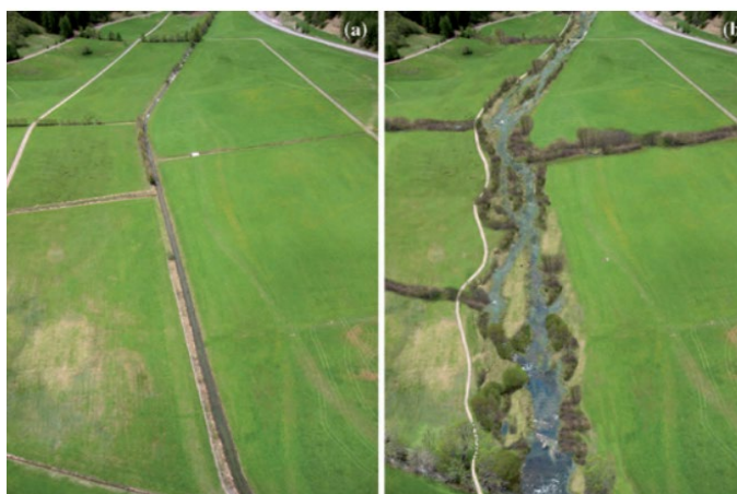
Figura 13. Canalización (a) y posterior restauración (b) del río Rombach en Fuldera (Suiza). Fotos: Pio Pitsch.
